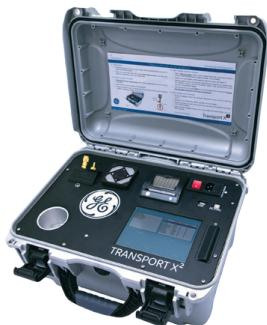
Analisador DGA 7 gases + umidade portátil. Fornece resultados e análise utilizando ferramentas de diagnósticos estabelecidas em normas internacionais. Possui impressora embutida, IHM LCD touchscreen e peso de aproximadamente 11kg.
